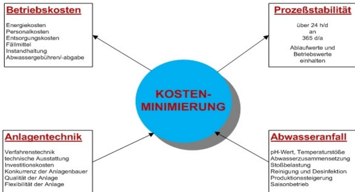
Bei bestehenden betrieblichen Kläranlagen gilt es, mit der vorhandenen Anlagentechnik und den betrieblichen Einflüssen auf die Abwasserqualität, die Betriebskosten der Abwasser-Anlage bei ausreichend hoher Prozessstabilität zu minimieren. Hierbei berät das Büro Abwasser König umfassend für Kläranlagen unterschiedlicher Hersteller und Verfahrenstechnik. Eine Spezialität ist die Optimierung von Abwasser-Anlagen nach dem SBR-System Schwander.
